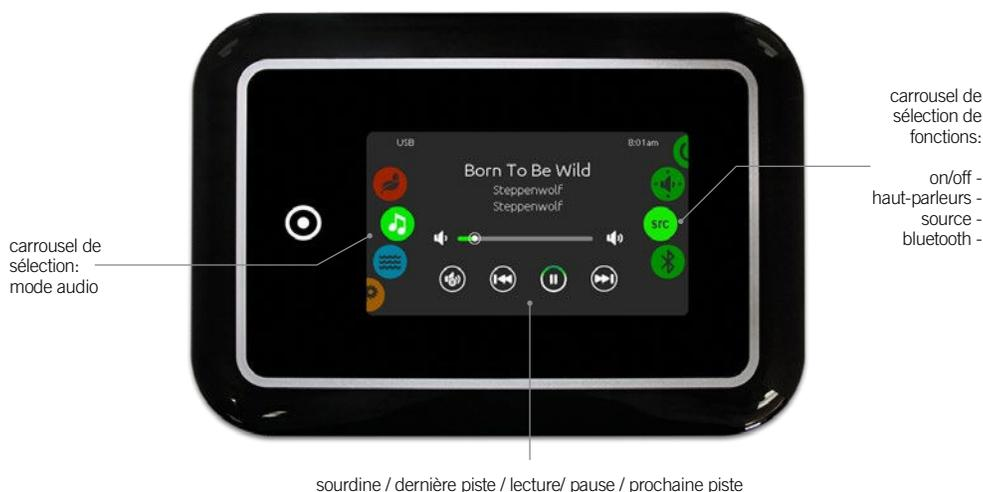
Pour sélectionner le mode audio, faites tourner le carrousel gauche vers le haut ou vers le bas jusqu'à ce que l'icône du mode audio s'allume au milieu de l'écran.
