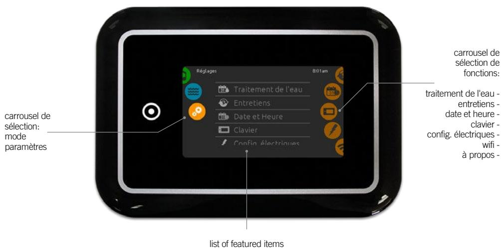
Pour sélectionner le mode paramètres, faites tourner le carrousel gauche vers le haut ou vers le bas jusqu'à ce que l'icône du mode paramètres s'allume au milieu de l'écran.
