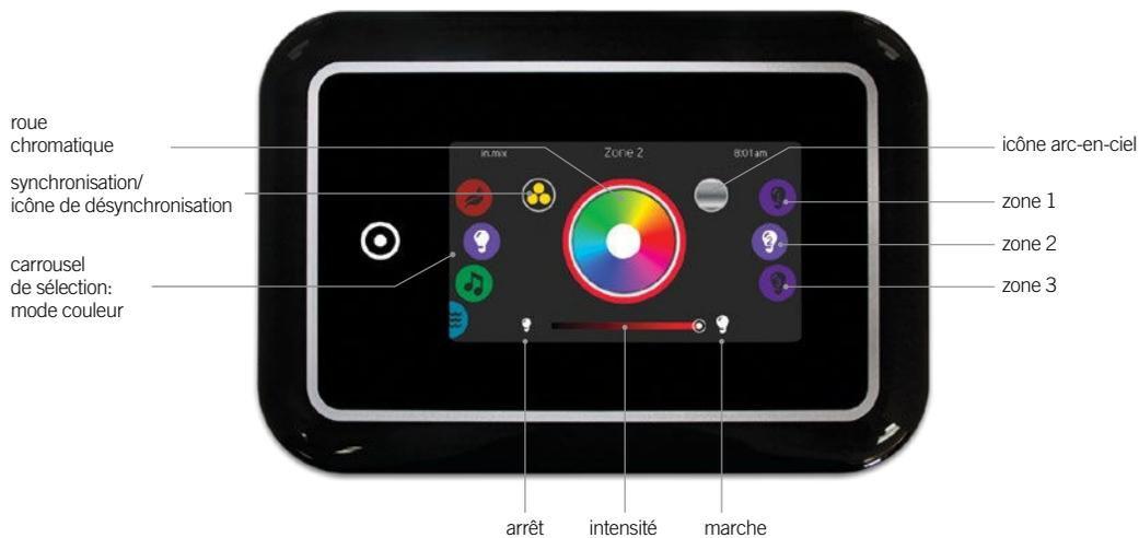
Par défaut, in.mix sélectionne la Zone 2 lorsque vous accédez au menu. Pour sélectionner le mode couleur, faites tourner le carrousel gauche vers le haut ou vers le bas jusqu'à ce que l'icône du mode Couleur s'allume au milieu de l'écran.
