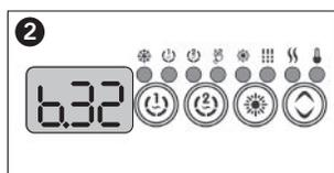
系统显示的值为GFCI最大安培值容量的80%。
